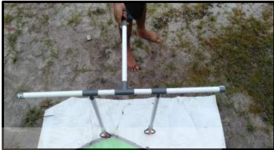
Gambar 4.17. Pipa Sprinkler tampak atas
